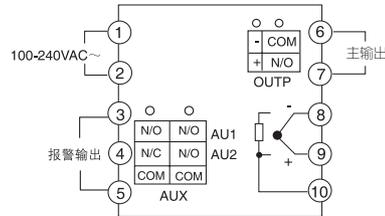
注 1：热电偶应用补偿导线直接接入仪表后盖输入端子上，中间不得转用普通导线连接，并注意补偿导线型号与极性的正确。
