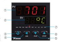
输入的测量信号超出量程时(热电偶断线时、热电阻断线或短路时及输入规格 设置错误时可能发生),则上显示窗交替显示"orAL"字样及测量上限或下限值。
